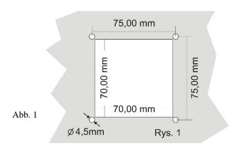
Nach Anfertigung der Montagebohrungen die vier Eckschrauben von der Zählerplatte lösen, Metallscheiben und Kunststoffbuchsen entfernen und die Platte an der vorbereiteten Stelle anbringen. Ziehen Sie dann die Platte mit zuvor abgeschrauben Schrauben an der Steuertafel an, setzen Sie die Hülse und die Unterlegscheibe ein und ziehen Sie sie schließlich mit der Befestigungsschraube fest.
