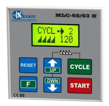
Der Mikroprozessorzähler MLC-02/03 wird zur Steuerung des Schleifzyklus einer automatischen Schärfmaschine für Kreis- und Bandsägeblätter verwendet.
